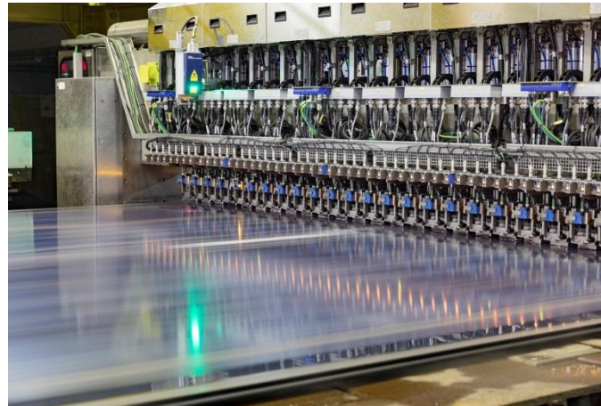
Bild 4: Die D-TECT-Technik von Dillinger testet Bleche auf hundertprozentiges Nichtvorhandensein von Hard Spots.
