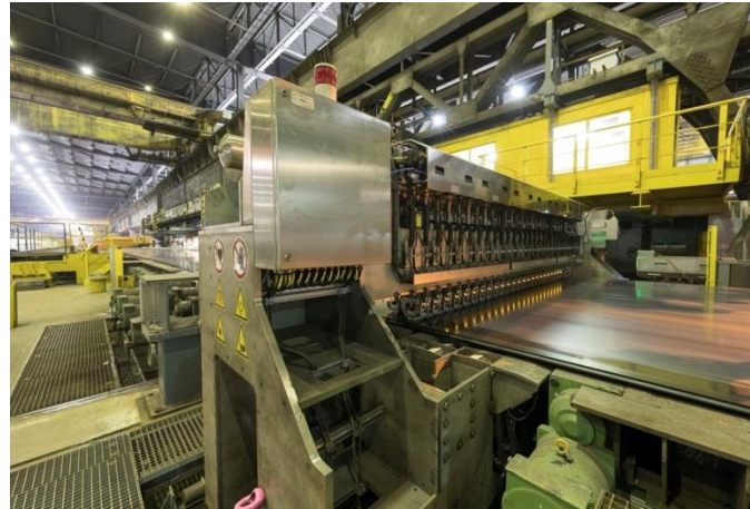
Bild 2: Die neu entwickelte Prüftechnik D-TECT von Dillinger ermöglicht es – bereits während des Produktionsprozesses – Hard Spots an Blechen zu detektieren.
