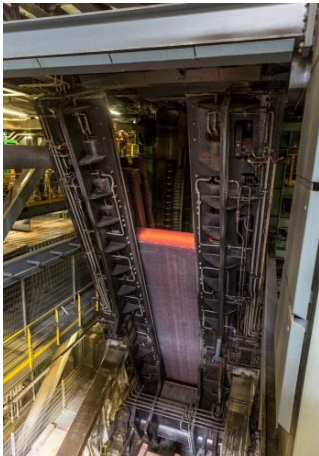
Bild 3: Die Stranggießanlage CC 6 unterstreicht heute schon die führende Rolle von Dillinger in der Herstellung hochwertiger Stranggussbrammen.
