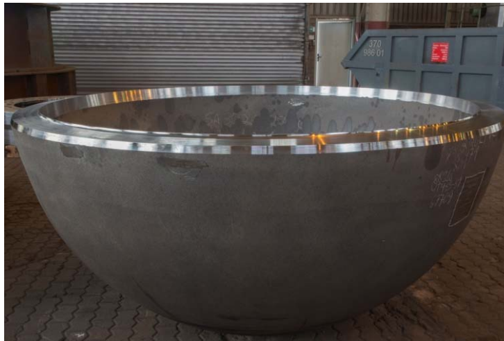
Bild 16: Einteiliger Halbkugelboden mit gedrehter Schweißnahtvorbereitung
