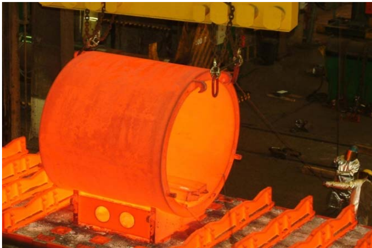
Bild 11: Wärmebehandlung Mantelschuss mit 240 mm Wanddicke
