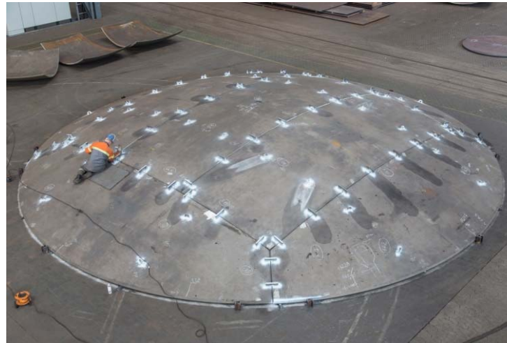
Bild 18: Probemontage eines mehrteiligen Halbkugelbodens mit 10.000 mm Durchmesser und 25 mm Wanddicke
