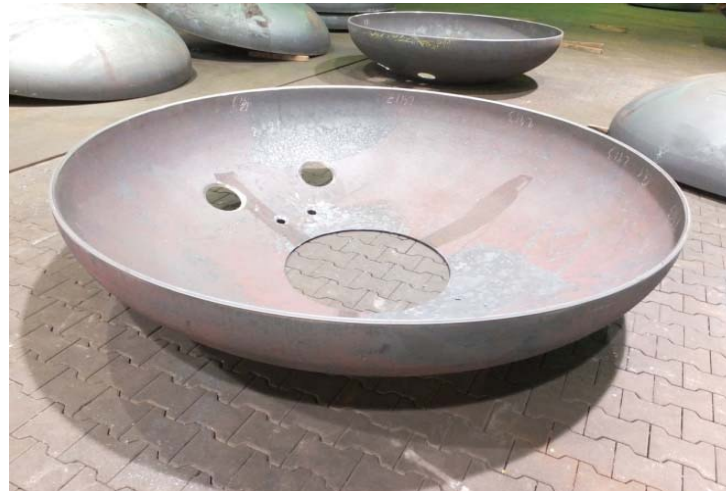
Bild 24: Kundenindividuelle Pakettlieferung: hier einteilige Böden mit Stützenlöchern
