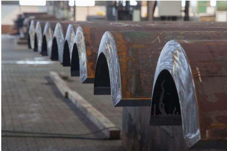
Bild 21: Chords, warm umgeformt (gequettet & angelassen)
