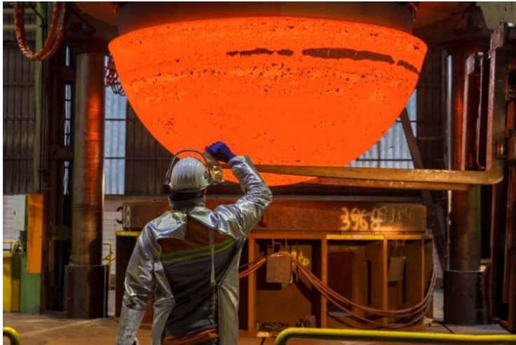
Bild 13: Umformung eines einteiligen Halbkugelbodens mit 3.800 mm Durchmesser
