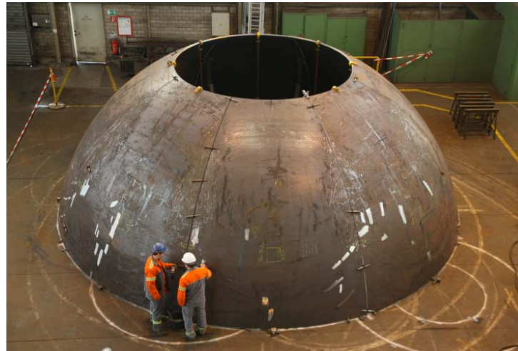
Bild 18: Probemontage eines mehrteiligen Halbkugelbodens mit 10.000 mm Durchmesser und 25 mm Wanddicke
