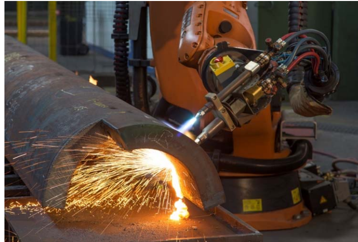
Bild 22: Robotergestützte Kantenbearbeitung bei einem Chord mit 120 mm Wanddicke aus der Stahlsorte S690Q mod.
