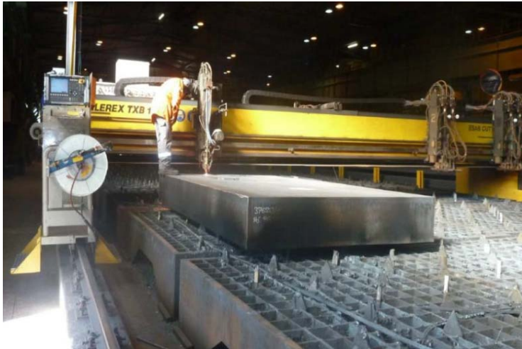
Bild 1: Thermisches Schneiden bis 430 mm Blechdicke und 45 t Stückgewicht
