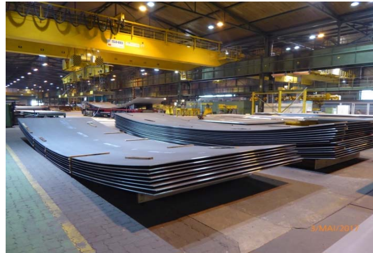
Bild 6: Einbaufertige, passgenaue Bauteile – kantenbearbeitet und vorgebogen für Tankbehälterbau
