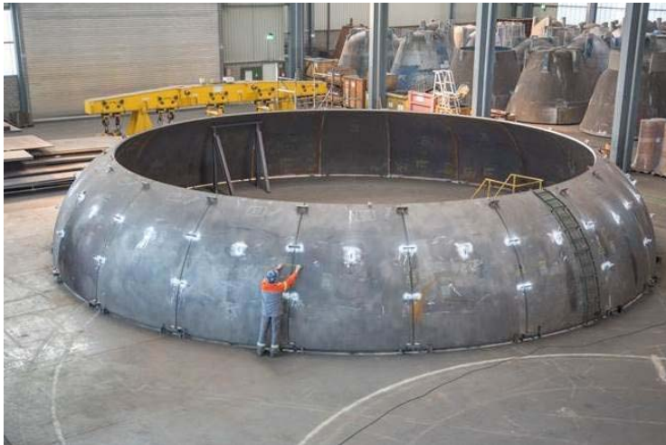
Bilder 19+20: Montagearbeiten an einem Korbbogenboden im Presswerk
