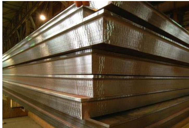
Bild 4: Bleche mit kundenindividuell gefräster Schweißnahtvorbereitung
