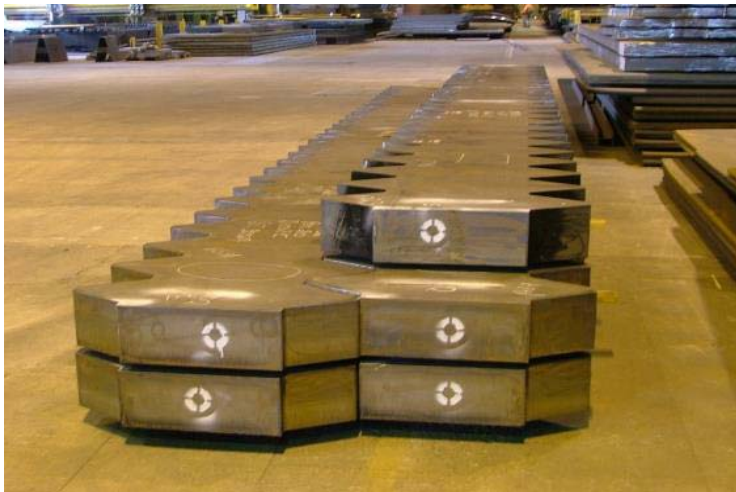
Bild 3: Zahnstangen bis 250 mm Dicke für Jack-Up-rig
