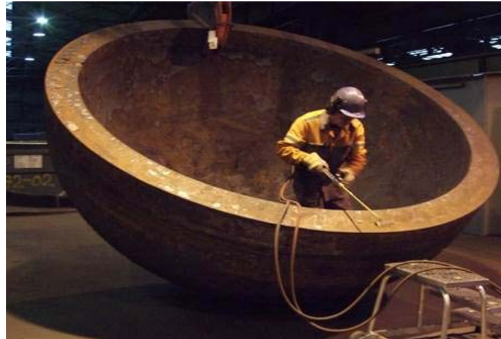
Bild 14: Einteiliger Halbkugelboden mit Wanddicke 200 mm
