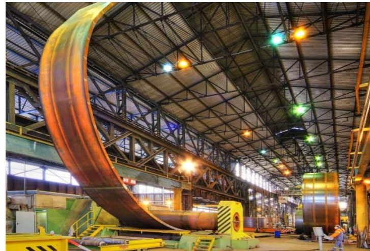
Bild 8: Umformung Mantelschuss mit zwei Längsnähten
