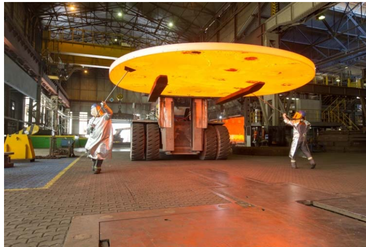
Bild 12: Vorgewärmte Ronde vor der Umformung zu einem dickwandigen, einteiligen Halbkugelbodens mit 3.600 mm Durchmesser
