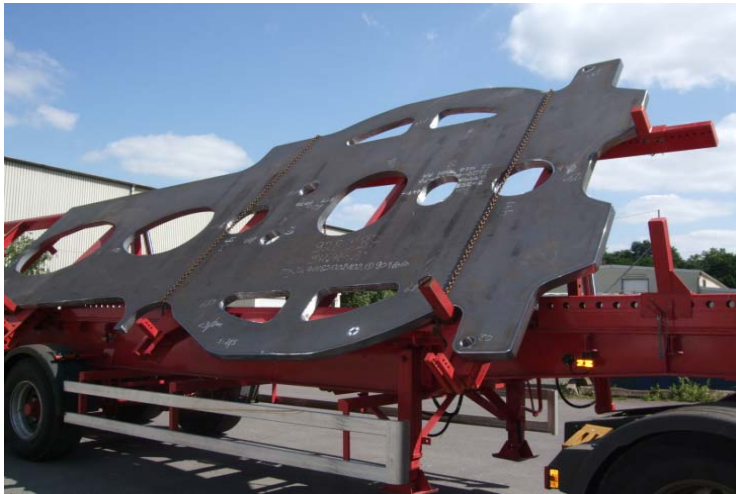
Bild 5: Präzise Brennteile „just-in-time“ für Baumaschinen und Maschinenbau
