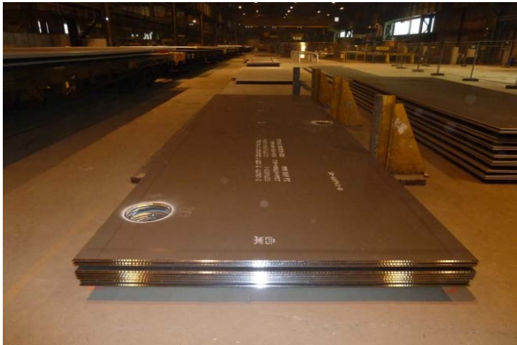
Bild 23: Just-in-time-Herstellung von einbaufertigen Mantelblechen für Gascontainer
