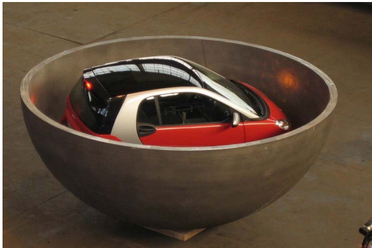
Bild 15: Einteiliger Halbkugelboden mit 3.450 mm Durchmesser
