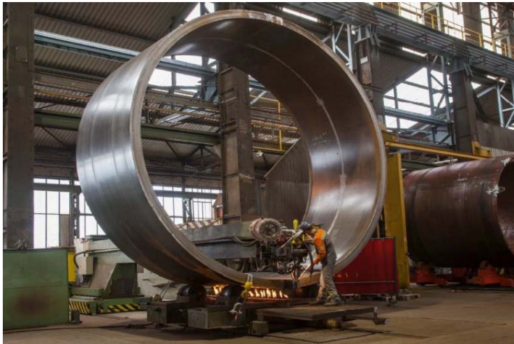
Bild 9: Schweißen eines kaltumgeformten Mantelschusses aus zwei Längsnähten, 180 mm Wanddicke
