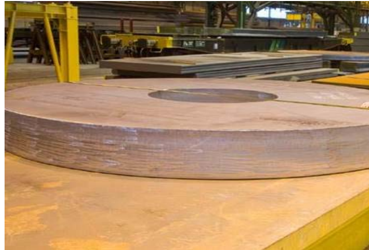
Bild 2: Großes, schweres Ringsegment mit 305 mm Dicke für ein Wasserkraftwerk
