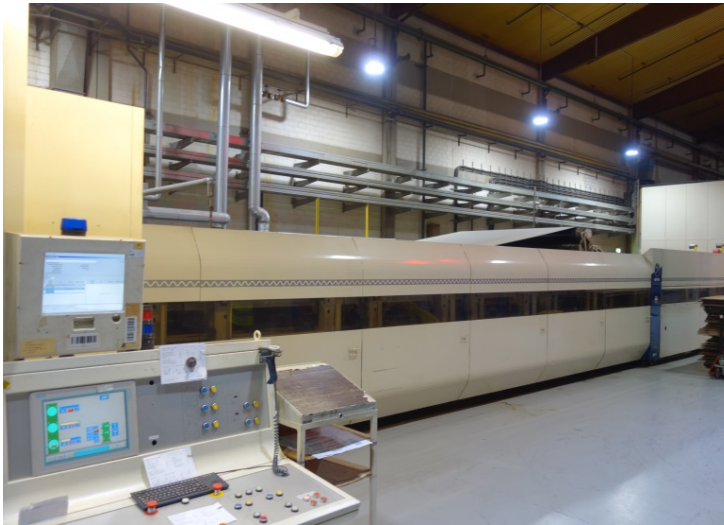
Bild 1: Die Heiz- und Zugpartie bei Nestler ist mit 18 Heizplatten belegt.
