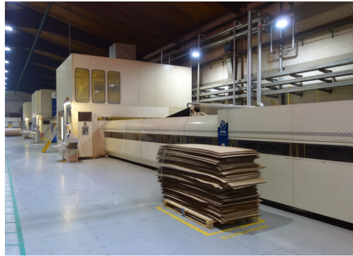
Bild 2: Die 16 Meter lange Heiz- und Zugpartie der BHS-Wellpappenanlage bei Nestler arbeitet mit einem Plate-Roll-Anpresssystem, das Schuhe und Rollen kombiniert.
