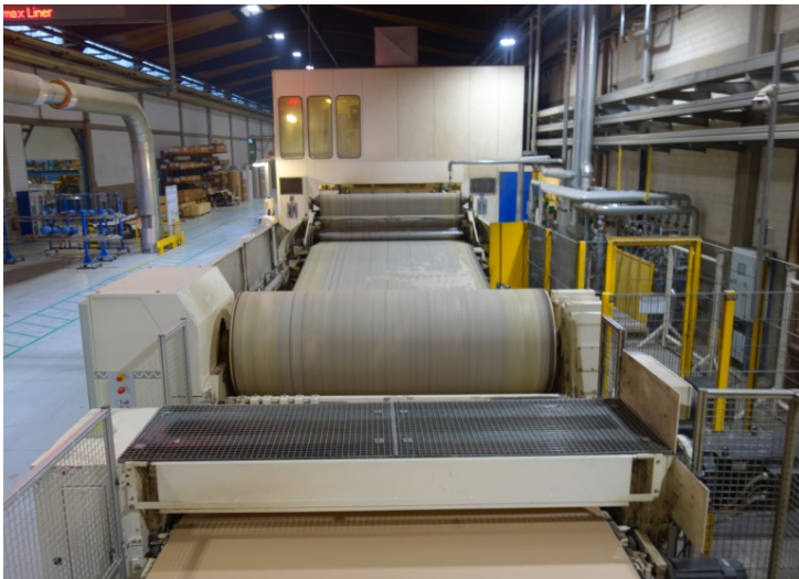
Bild 3: Der CONDUCTO® 3322 ermöglicht das sofortige vollflächige Ausdampfen der Wellpappe.
