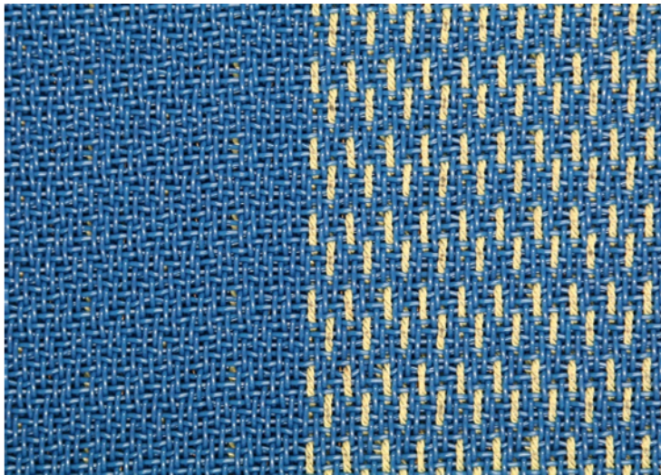
Bild 7: Die Konstruktion aus Polyester-Monofilien mit Aramid-Verstärkung im Randbereich und in Laufrichtung eingewebten Bronzedrähten macht den Heizgurt CONDUCTO® 3313 im Vergleich zu marktüblichen Produkten deutlich leichter.
