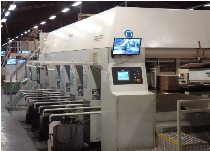
Bild 11: Nestler arbeitet mit Flexo-Direktdruck mit bis zu sieben Farben (HQPP).
