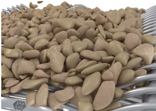
Bild 1: Simulation des Porometric-Gewebes von GKD mit Sandpartikeln.
