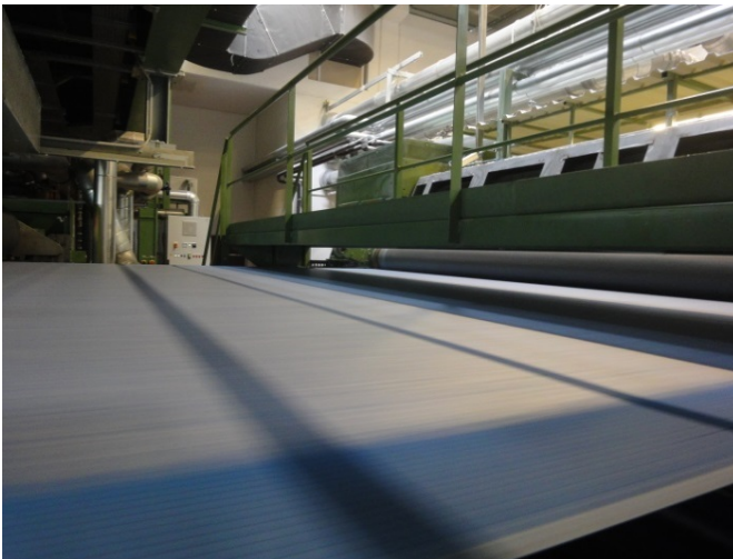
Bild 4: Die deutlich rauere Bandstruktur in Umlaufrichtung sorgt für einen hohen Mitnahmeeffekt im Ablagebereich bei gleichzeitig optimaler Vliesabnahme.
