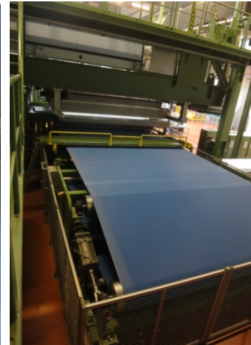
Bild 3: Durch ein besseres Reinigungsverhalten erhöht das GKD-Ablageband die Effizienz des Gesamtprozesses.
