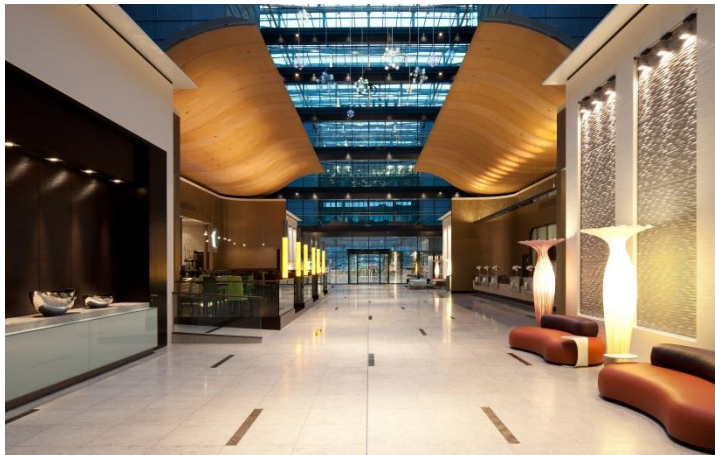
Bild 4: Zwei goldene, großformatige Deckenflügel aus Bronzegewebe vom Typ Mandarin über der Rezeption des Hilton Frankfurt Airport Hotels.
