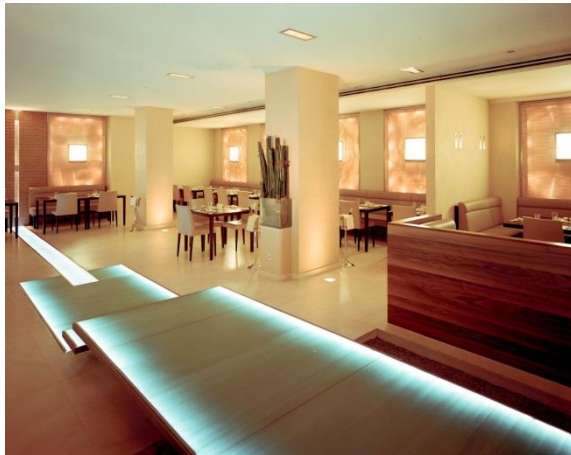
Bild 1: Mehrschichtige Wandbekleidung aus hinterleuchtetem Bronzegewebe vom Typ Mandarin im Kölner Feinschmeckerrestaurant „Taku“.
