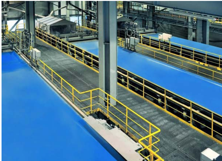
Bild 4: In der REA-Gips-Entwässerung in Kohlekraftwerken ist das Filterband VACUBELT® 2015 seit Jahren weltweit etablierter Standard.
