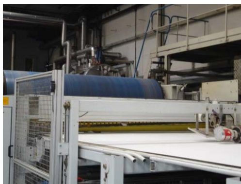
Bild 5: Heizgurt von GKD für die Produktion von Wellpappe.
