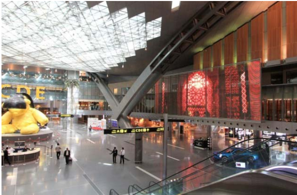
Bild 6: Vier großformatige MEDIAMESH®-Screens aus Edelmetallgewebe mit integrierten LED-Profilen von GKD-CREATIVE WEAVE wurden am Hamad International Airport in Katar installiert.
