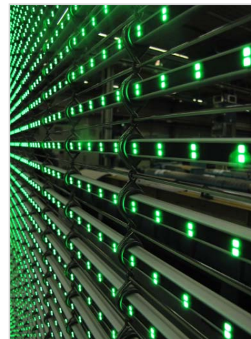
Bild 3: Mediamesh® mit RGB-SMD-LEDs als Outdoor-System
