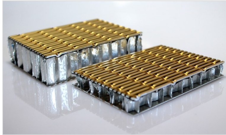
Bild 1-2: Zwei Varianten des akustisch hochwirksamen Composite (CMP)-Gewebes mit 12 bzw. 25 mm Wabenträgerplatte und einer Decklage aus goldfarben eloxiertem Alu 6010 Gewebe.
