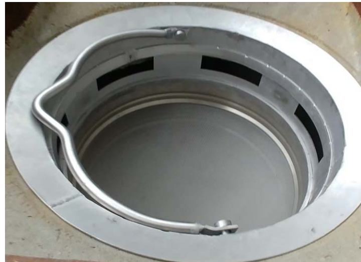
Bild 4: Im Rahmen des Projektes RAU entwickelte GKD einen Probenahmekorb, der in herkömmlichen Straßengullys anstelle der üblichen Laubfangkörbe eingesetzt wird.
