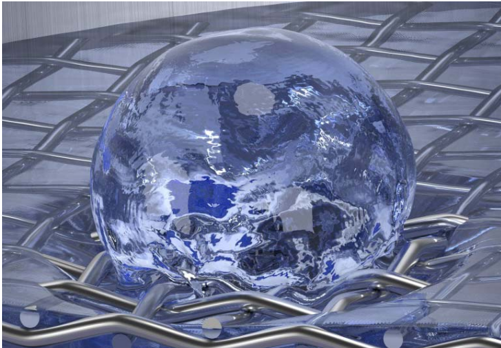
Bild 3: Mit einem im eigenen Haus entwickelten Verfahren, das den Bubble-Point mit Hilfe von CFD-Simulationen ermittelt, kann GKD jede Porengröße schnell und verlässlich bestimmen.
