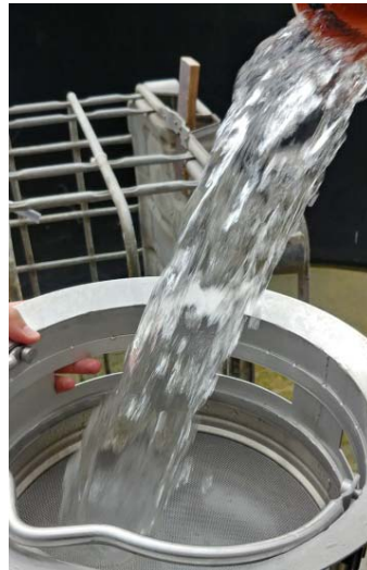
Bild 7-8: Der Probenahmekorb von GKD ist aktuell im Praxistest in Berlin.
