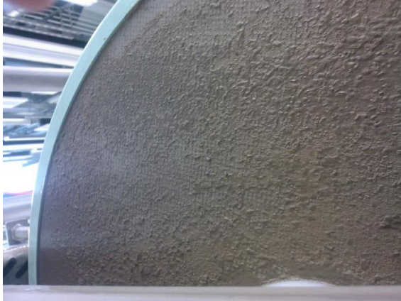
Bild 9: Per automatisierter Rückspülung wird der Filterkuchen von den Scheiben gelöst.
