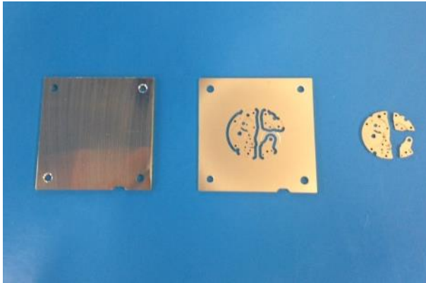
Bild 5: Aus der quadratischen Form der Ursprungsplatte wird die technisch perfekt ausgelegte, runde Platte ausgefräst.
