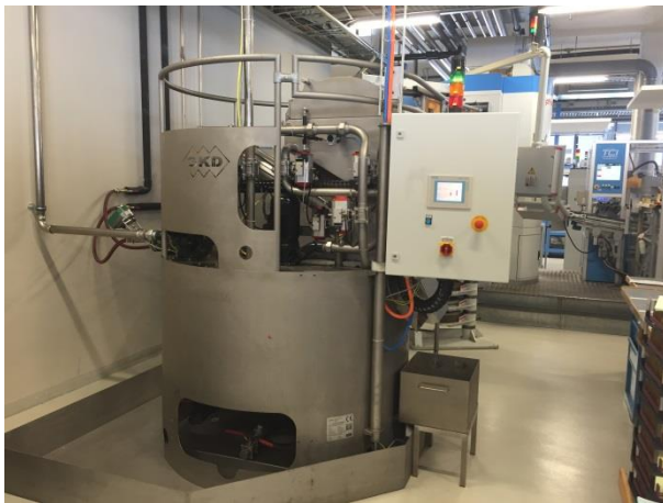
Bild 7: Der Kompaktfilter MAXFLOW CS 1000 vereint Filtration und Brikettierung in einer Anlage
