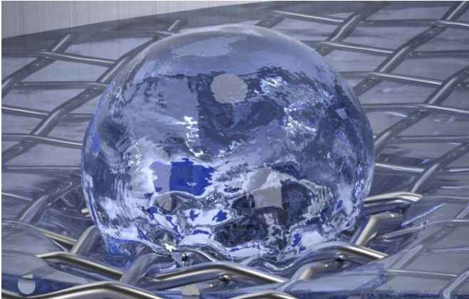
Bild 1: Visualisierung eines Blasendurchbruchs beim Bubble-Point-Test.
