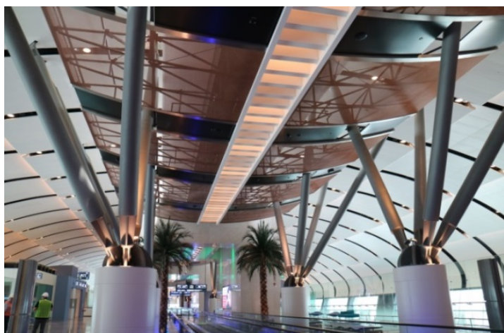
Bild 4: GKD beschichtete ein neues LAMELLE-Gewebe im Durchlaufverfahren bronzefarbig für die bogenförmigen Baldachine über den Fahrsteigen des Flughafens Muscat.
