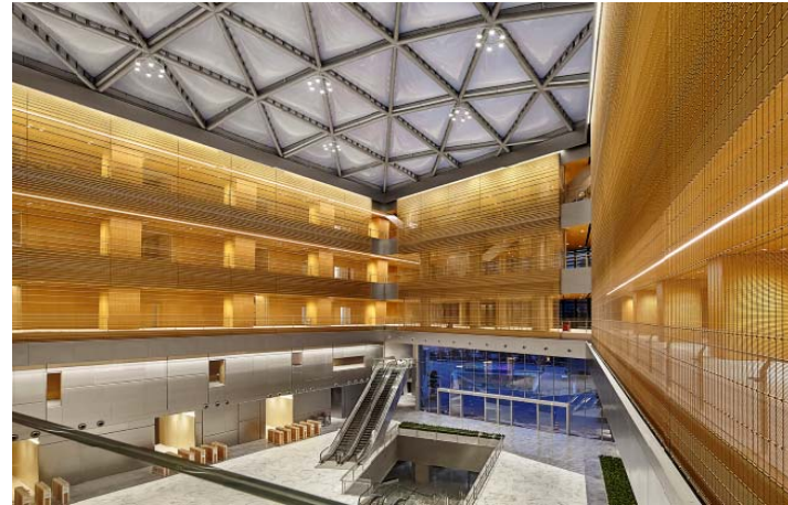
Bild 7: Im Hauptquartier des chinesischen Internetgiganten Tencent verkleidet ein golden eloxiertes GKD-Sondergewebe das dreigeschossige, offene Atrium.
