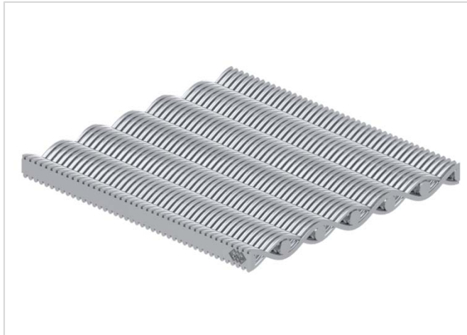
Bild 4: Für jedes Gewebe, wie das Optimierte Tressengewebe (OT) von GKD, wurde eine Kapillardruckkonstante errechnet, um konkrete Aussagen über die Porengröße treffen zu können.
