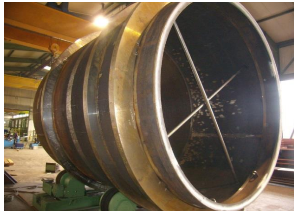
Bild 10: Zur Minimierung von Kranbewegungen nutzte Wessel eine eigens angepasste Fertigungsvorrichtung mit Rollgang.
