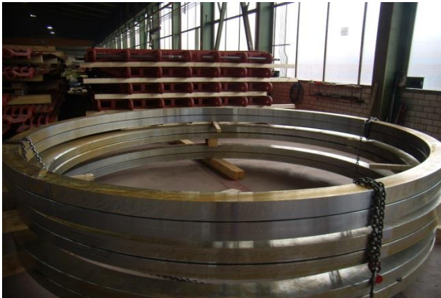
Bild 5: Massive Vollringe verstärken den konischen Pfannenmantel.
