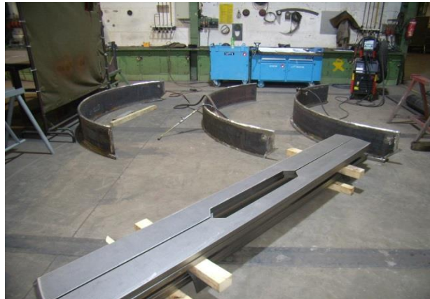
Bild 4: Neben den Rippen mit gewollter Torsion fertigte Jebens auch die Fußteile der Pfanne.
