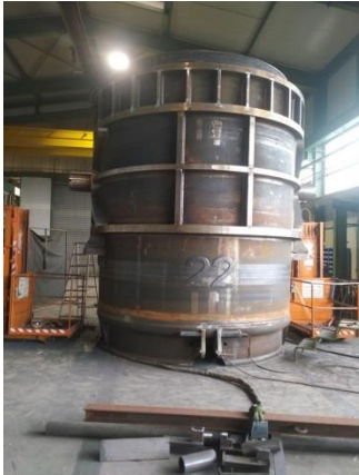
Bild 13: Die leicht kegelförmige Pfanne mit den ersten Anbauteilen.
