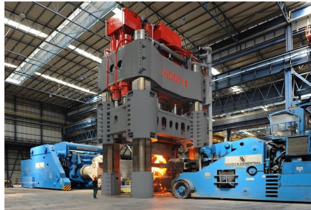
Bild 12: Dango & Dienenthal erteilte Jebens bereits Folgeaufträge für zwei weitere Hauptrahmen für schienengebundene Schwiedemanipulatoren vom Typ SSM 6000.
