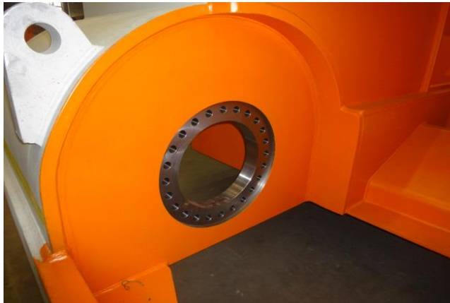
Bild 9: Jebens fertigt Bauteile exakt nach Zeichnung, sodass Dango & Dienenthal unmittelbar mit der mechanischen Bearbeitung beginnen kann.
