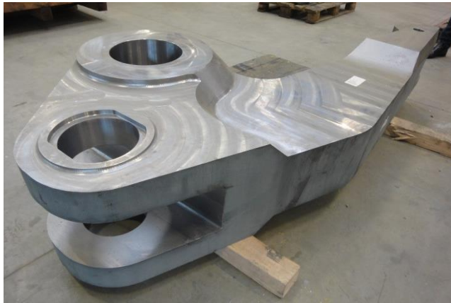
Bild 5: In der zweiten Phase der Zusammenarbeit fertigte Jebens Zangenteile aus S690.
