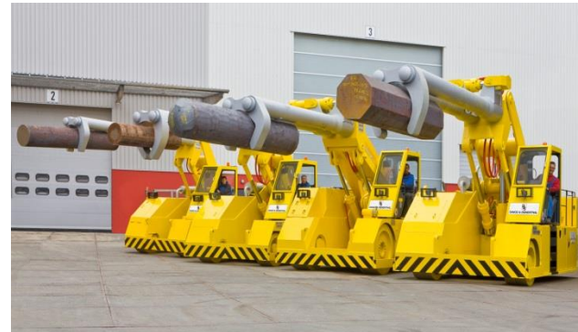
Bild 2: Eine Besonderheit sind die Transportmanipulatoren von Dango & Dienenthal mit integrierter Schriedefunktion.
