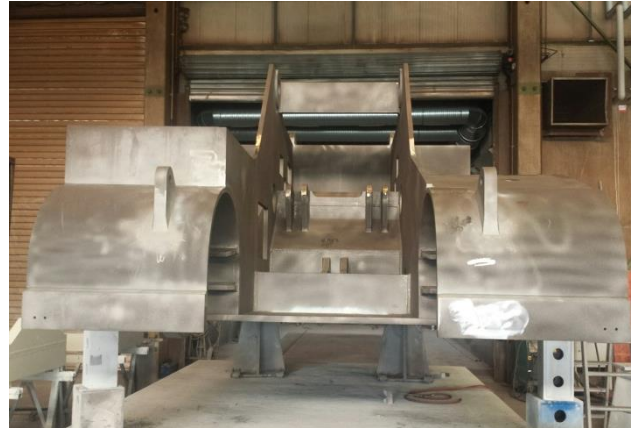
Bild 6: Jebens fertigte einen 30 Tonnen schweren Hauptrahmen für einen mobilen Transportmanipulator vom Typ MTM 600 des Siegener Familienunternehmens.
