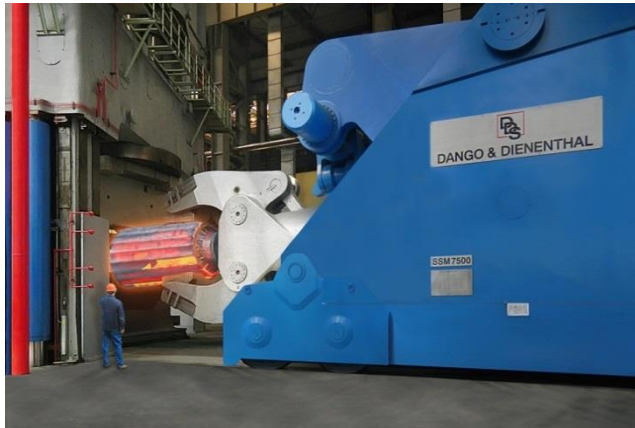
Bild 1: Die größten Schriedemanipulatoren von Dango & Dienenthal haben ein Gewicht von 1.000 Tonnen und können bis zu 250 Tonnen heben und bewegen.
