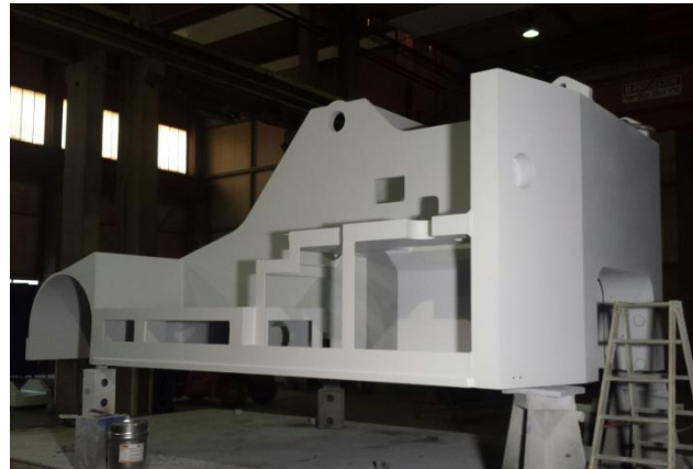
Bild 8: Nach dem Glühen wurde der Hauptrahmen des Transportmanipulators MTM 600 bei Jebens gestrahlt und grundiert.
