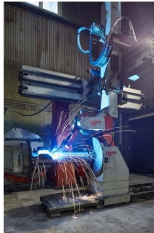
Bild 6: Bei mehrlagigem Schweißen gibt der Einsatz von Schweißrobotern in Korntal-Münchingen und Nördlingen die Gewissheit absolut gleichmäßiger und fehlerfreier Schweißnähte.
