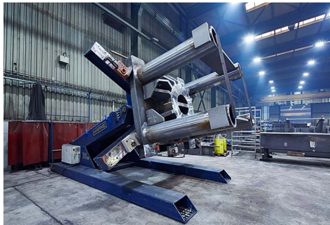
Bild 4: Auf dem Drehtisch bearbeitet Jebens bis zu 35 Tonnen schwere Baugruppen.
