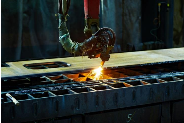
Bild 5: Jebens fertigt mit dem Faserroboter individuelle, konturverlaufende Fasen und schneidet in mehreren Ebenen.
