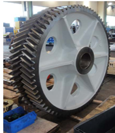
Bild 12 - 13: Plus an Stabilität: Eine entscheidende Rolle für Stabilität, Schwingungsfreiheit und Standzeit des Jebens-Pressentischs spielt das Triebwerk mit vierfach gelagerter Exzenterwelle.
