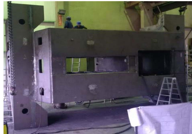
Bild 4: Präzision und Performance: Die Herstellung des Pressentischs war eine echte Herausforderung für den Schweißexperten aus Korntal-Münchingen.
