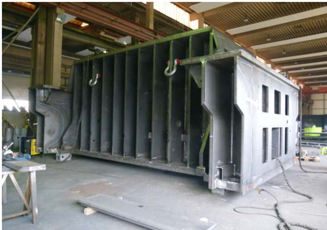
Bild 3: Maßarbeit in Stahl: Bei der Fertigung des 156-Tonnen-Koloss galt es für den Schweißexperten aus Korntal-Münchingen, minimale Toleranzen einzuhalten.
