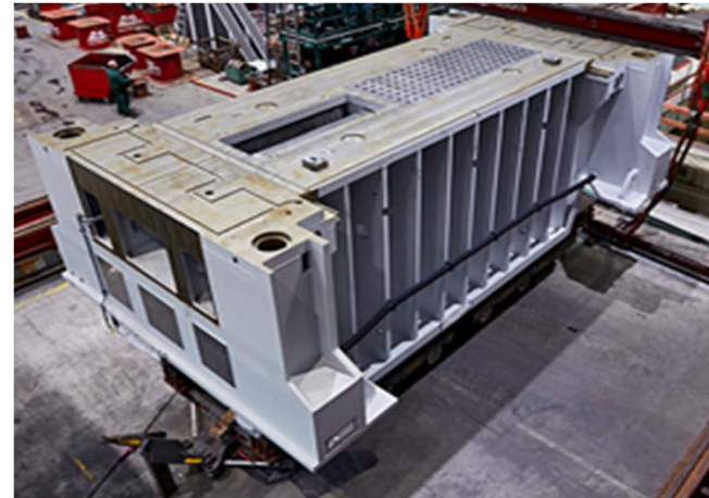
Bild 1 - 2: 3.620 Millimeter hoch, 4.950 Millimeter lang und 7.950 Millimeter hoch: ANDRITZ Kaiser beauftragte Jebens als führenden Spezialisten für große schwere Brennzuschnitte und komplexe Schweißkonstruktionen mit der Fertigung des Pressentischs.
