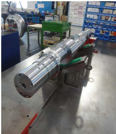
Bild 12 - 13: Plus an Stabilität: Eine entscheidende Rolle für Stabilität, Schwingungsfreiheit und Standzeit des Jebens-Pressentischs spielt das Triebwerk mit vierfach gelagerter Exzenterwelle.
