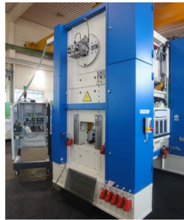
Bild 9 - 10: Ihr kompaktes Design verdanken die Servo-Pressen der Integration von Öltank und Hydraulikaggregaten in die Maschine.
