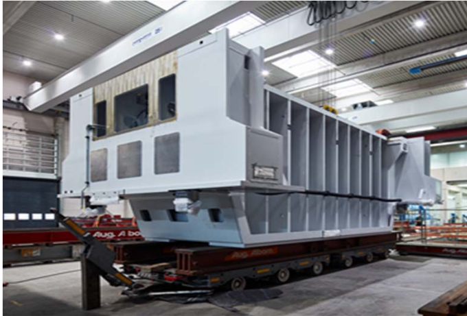
Bild 1 - 2: 3.620 Millimeter hoch, 4.950 Millimeter lang und 7.950 Millimeter hoch: ANDRITZ Kaiser beauftragte Jebens als führenden Spezialisten für große schwere Brennzuschnitte und komplexe Schweißkonstruktionen mit der Fertigung des Pressentischs.
