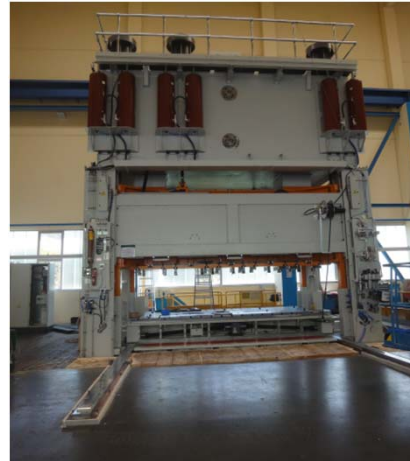
Bild 6: Exakt nach Kundenvorgabe stellt Jebens die Schweißkomponenten für den über 8 Meter langen Pressentisch her.
