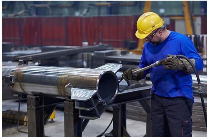
Bild 8: Nach dem Schneiden und Bohren der Grundplatte bearbeitet Jebens eine Reihe weiterer Einzelteile – neben den Seitenelementen beispielsweise auch Zukaufteile wie Rohre.
