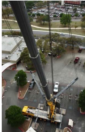
Bild 1-2: Der GMK6400, einer der leistungsstärksten sechsachsigen All-Terrain (AT)-Krane auf dem Markt, wird von Manitowoc gebaut. Die Grundplatte fertigt der Schweißbauspezialist Jebens GmbH.
