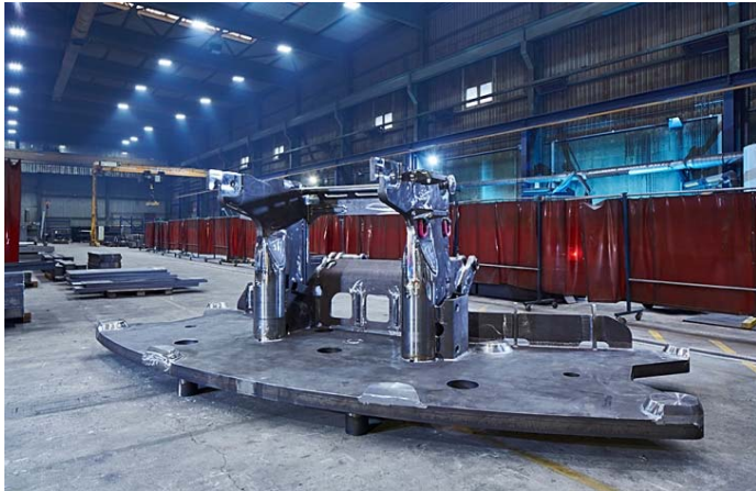
Bild 7: Eine entscheidende Rolle für die Stabilität des Krans spielt naturgemäß die Grundplatte. Sie wird von der Jebens GmbH geschnitten und zur fertigen Baugruppe verarbeitet.
