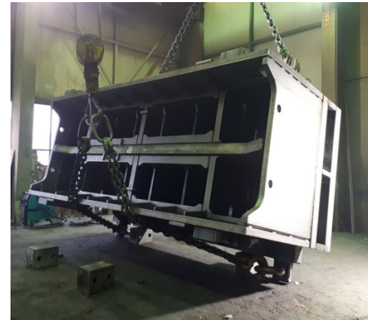
Bild 2+3: Jebens berechnete nach der Zeichnung von Ropa alle Schweißnähte neu und legte sie entsprechend aus.
