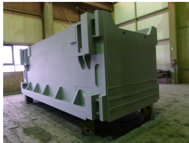
Bild 5: Stößel im XXL-Format made by Jebens: 66 Tonnen schwer, 2.600 Millimeter hoch, 2.200 Milli-meter breit und 6.000 Millimeter lang.
