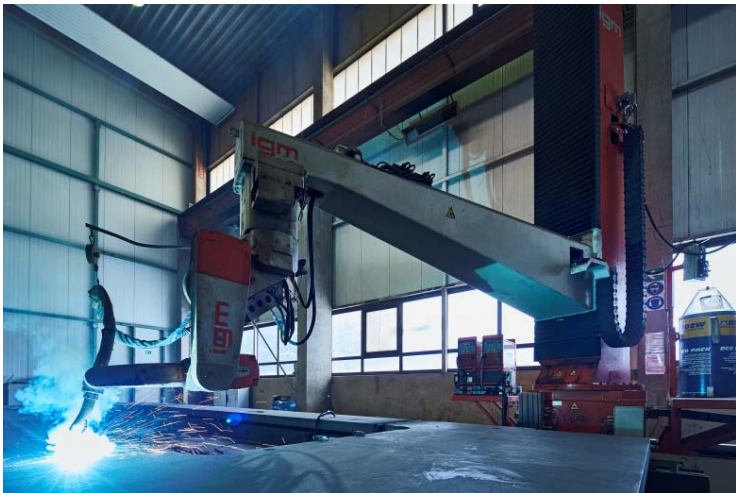
Bild 3: Der Schweißroboter von Jebens sorgt für Präzision von Format
