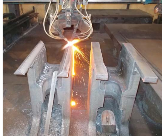
Bild 2: Für die Ausklinkungen der Werkstücke der Schuler-Gruppe sind sehr unterschiedliche Schnitthöhen, -breiten und -tiefen zu realisieren.
