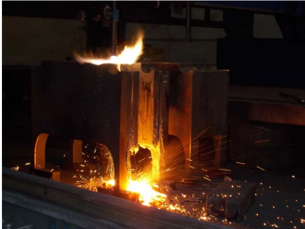
Bild 1: Für die Schuler-Gruppe werden aus einer 30 Tonnen schweren Stahltafel 400 x 710 x 840 Millimeter große Werkstücke gefertigt und dafür große Segmente mit engen Radien abgetragen.
