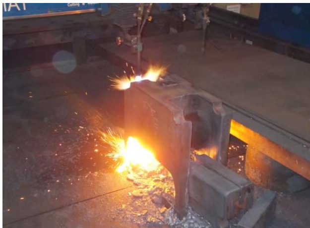
Bild 3: Ganz ohne Fräsen fertigt Jebens nur mit der Flamme selbst aufwändige Geometrien exakt nach Kundenvorgabe.
