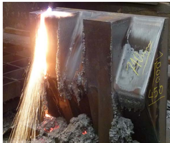
Bild 4: Aus einem 450 Millimeter dicken und 1.000 Millimeter hohen Block werden mit der Flamme vier durch einen Steg getrennte Schrägen geschnitten.
