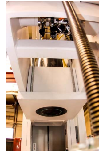
Bild 8: Der mittig im Oberjoch montierte Hydraulikzylinder verriegelt sich selbstständig auf der neuen Position.
