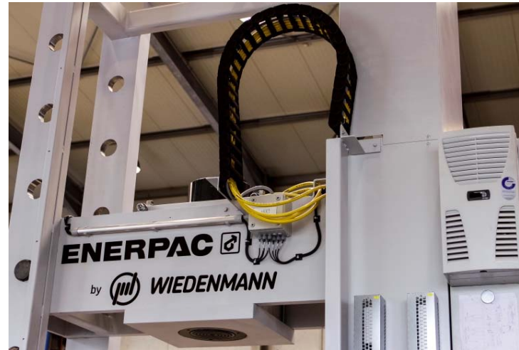
Bild 5: Die in der Stahlmanufaktur massiv geschweißte und komplett elektrifizierte Rollrahmenkonstruktion ist um 1.750 Millimeter verfahrbar.
