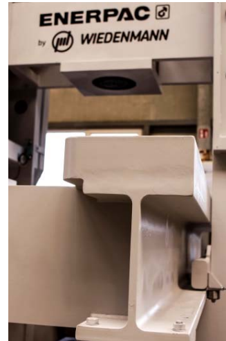
Bild 7: Bleche der Güte S690 QL verwendete Jebens, um die geforderte Druckbelastung von 3.193 kN zu gewährleisten.
