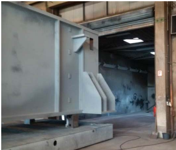
Bild 3: Das Lohnglühn im riesigen Glühhofen ermöglicht es, die Werkstoffeigenschaften gewichtiger Schweißkonstruktionen zu optimieren.
