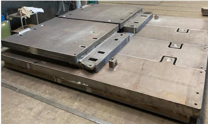
Bild 1: Die 150 Tonnen schwere Baugruppe für die Fundamentplatte besteht aus sieben Einzelteilen mit Steckverbindungen.
