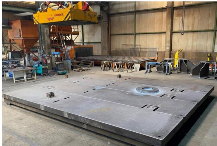
Bild 3: Vor der TÜV-Abnahme wurden die sieben Einzelteile für die interne Funktionsprüfung mit Steckverbindungen zu einer Einheit zusammengefügt.
