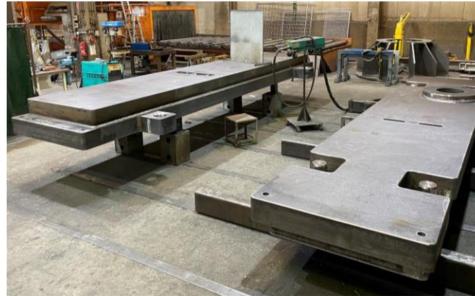
Bild 2: Vor der TÜV-Abnahme erfolgte eine interne Sicht- und Maßprüfung.
