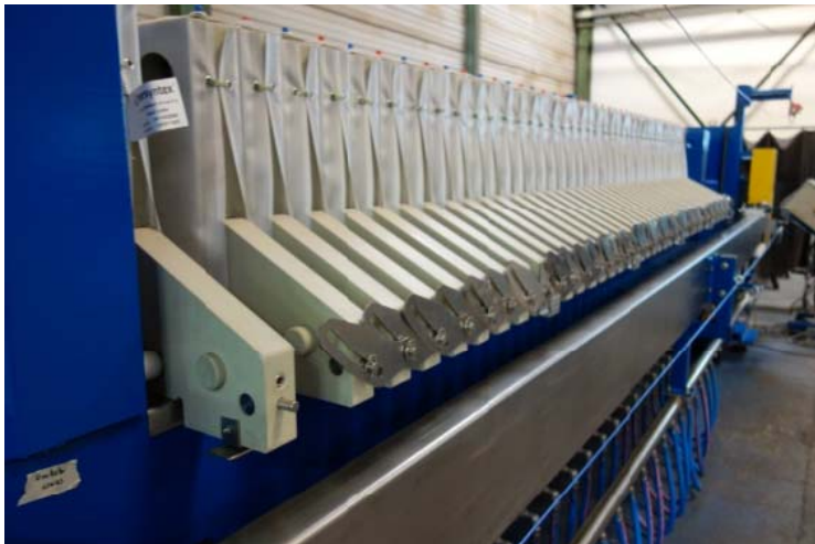
Bild 3: Seitenholmepresse von Filox für die Palmölfractionierung
