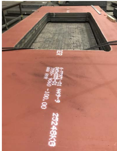
Bild 2: 100 mm dickes, 3.500 mm breites und 9.005 mm langes Brennteil für den Pressenrahmen.
