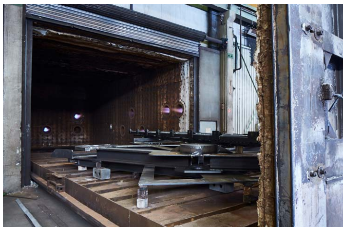
Bild 13: Den fast neun Meter langen Pressenrahmen glühte Jebens im Glühofen im Werk Nördlingen.
