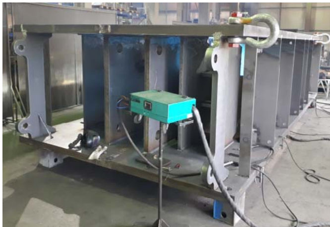
Bild 8: Die enormen Dimensionen der Brennteile erforderten laservermessene Maßarbeit in Stahl.
