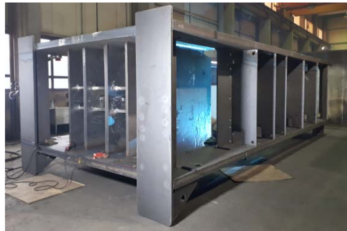
Bild 4-5: Die 66 Tonnen schwere Stahlbaugruppe für den Pressenrahmen bestand aus 77 Einzelteilen, die gebrannt, geschweißt, spannungsarm gegläht, mechanisch bearbeitet und grundiert wurden.
