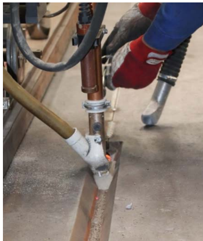
Bild 10: Hohe Qualität und Reproduktionsfähigkeit beim Schweißen von Vollanschlüssen durch teilautomatisiertes UP-Schweißen.
