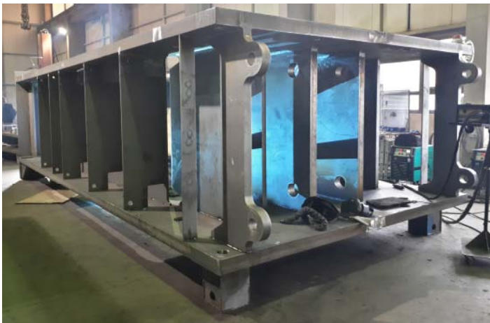
Bild 4-5: Die 66 Tonnen schwere Stahlbaugruppe für den Pressenrahmen bestand aus 77 Einzelteilen, die gebrannt, geschweißt, spannungsarm gegläht, mechanisch bearbeitet und grundiert wurden.
