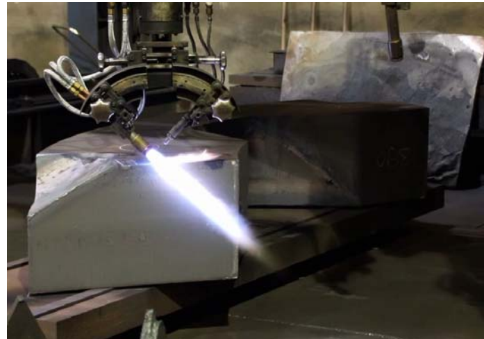
Bild 6: Seitlich wurden 45 Grad Fasen in zwei Ebenen geschnitten.
