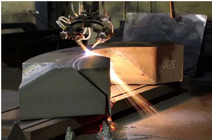
Bild 7: Angesichts der vorgegebenen engen Toleranzen bei dieser Blechdicke waren die geforderten Schnittschräge und -qualität dieser Fasen hohe Kunst.
