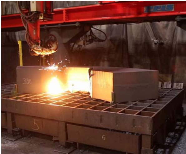
Bild 3: Jebens schneidet die bogenförmigen Brennteile mit sechs unterschiedlichen Fasen so präzise, dass diese Bauteile engste Toleranzvorgaben erfüllen.
