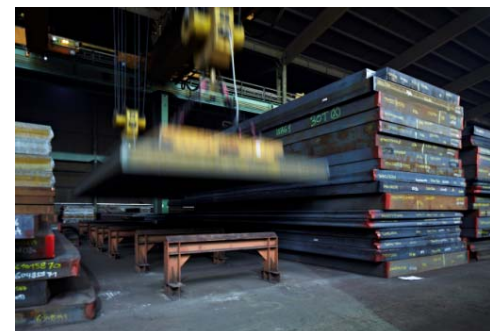
Bild 9: Die bis zu 1,7 Tonnen schweren Stahlplatten der Jebens GmbH haben eine tragende Rolle für die Schleuderbetonsäulen und damit für den Moscheebau insgesamt.
