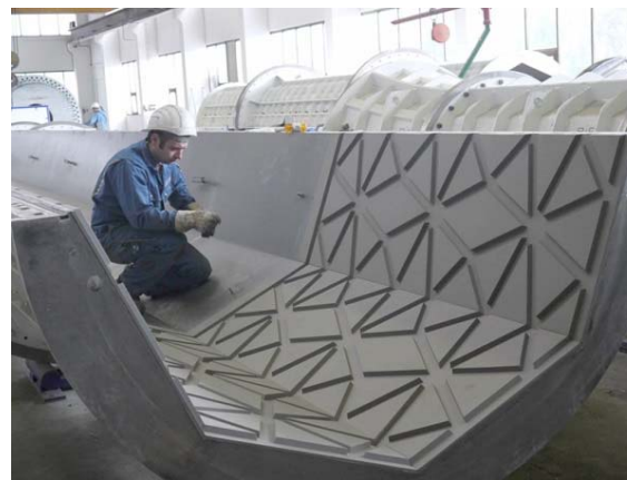
Bild 4: Die sternförmigen Reliefs der Moscheesäulen werden beim Schleuderprozess direkt mit geformt.
