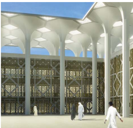
Bild 3: Dicht angeordnete achteckige Schleuderbetonsäulen der Firma Eurocoles bilden ein beeindruckendes Baldachindach.
