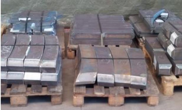
Bild 1: 24 spiralförmige Stahlrippen zur Verstärkung von zwei Stahlgießpfannen fertigte Jebens durch 3D-Brennen.
