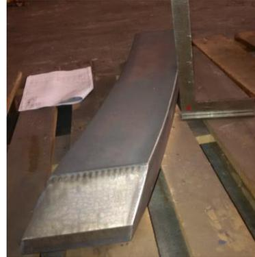
Bild 2: Kostenintensives Fräsen ersetzt Jebens auch bei anspruchsvollen Geometrien durch eine ausgeklügelte Brenntechnik
