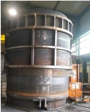
Bild 3: Die kegelförmige Pfannengeometrie wird rundum durch spiralförmig gebrannte Stahlrippen verstärkt.
