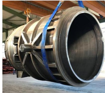
Bild 4: Die Verstärkungsrippen für diese Stahlgießpfanne wurden mit einer vorgegebenen Torsion gebrannt.
