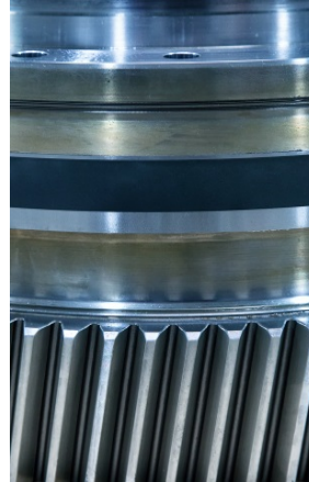
Bild 10: Die Beschichtung der 700 Kilogramm schweren Großbauteile muss absolut porenfrei sein, eine Rauheit von Ra 0,4 µm aufweisen und nach der Endbearbeitung drallfrei geschliffen sein.
