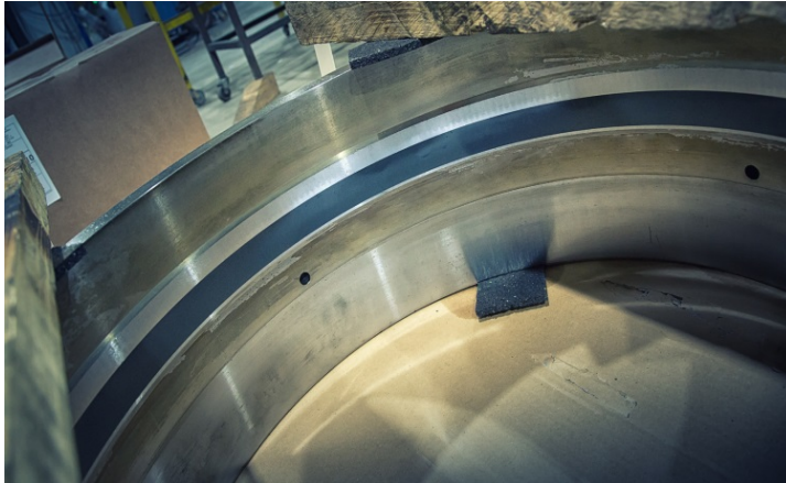
Bild 9: Pallas beschichtet den Außen- und Innensitz der Zahnräder in einer Aufspannung.
