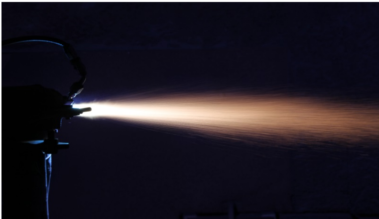
Bild 7-8: Partikel einer hochschmelzenden Keramikschicht bilden auf dem zu beschichtenden Substrat eine dichte, stark haftende Schicht mit hoher Maßgenauigkeit und Reproduzierbarkeit.
