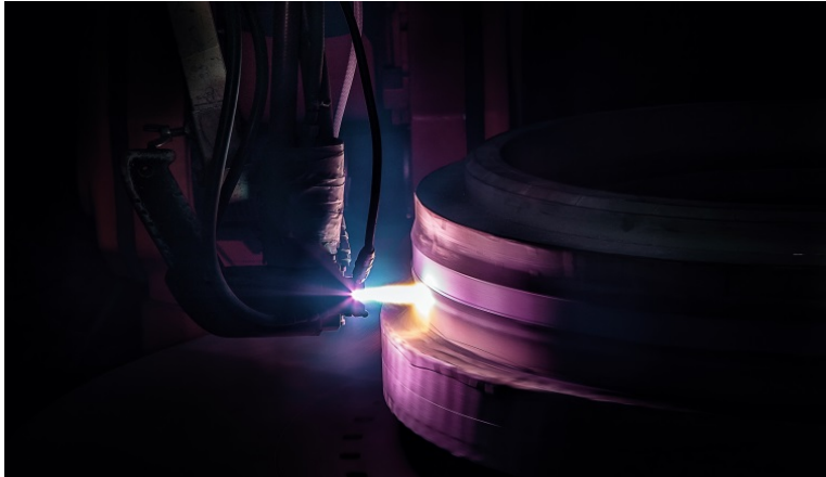
Bild 5-6: In eine 18.000°C heiße Plasmaflamme wird eine hochschmelzende, pulverförmige Keramikverbindung injiziert, die dort im Mikrosekundenbereich aufschmilzt und durch kinetische Energie auf die Werkstückoberfläche geschleudert wird.
