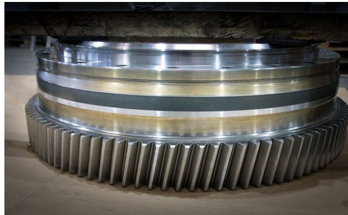
Bild 11-12: Deshalb werden die Zahnräder im letzten Bearbeitungsschritt innen und außen auf Endmaß geschliffen und poliert, damit das Komplettsystem die geforderte Dichte hat.
