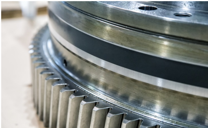
Bild 11-12: Deshalb werden die Zahnräder im letzten Bearbeitungsschritt innen und außen auf Endmaß geschliffen und poliert, damit das Komplettsystem die geforderte Dichte hat.
