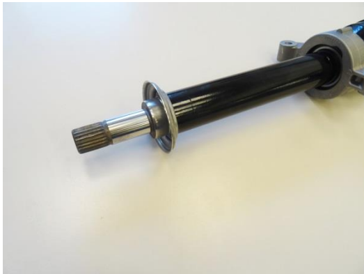
Bild 4-5: Die partielle Maskierung solcher Komponenten vor der Beschichtung erfordert viel Fingerspitzengefühl und Erfahrung bei Pallas.
