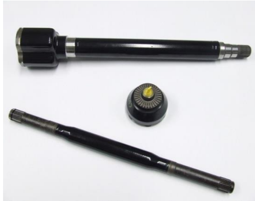
Bild 1-3: Damit Antriebselemente wie Linkshaft, Außengelenk und geknetete Hohlwelle im herausfordernden Prototypenstadium optisch halten, was sie technisch versprechen, lässt die Neapco Europe GmbH sie bei der Pallas GmbH & Co. KG mit PTFE beschichten.
