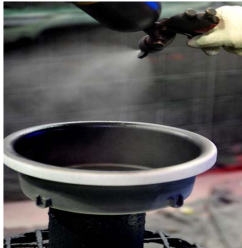
Bild 4-5: Auswahl mit Augenmaß: Bei einer Lackapplikation ist die Erreichbarkeit aller zu beschichtenden Oberflächen mit einer Lackpistole des Bauteils unverzichtbar, deshalb ist Pallas bereits in der Konstruktionsphase ein gefragter Ansprechpartner.
