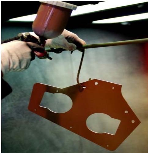
Bild 4-5: Auswahl mit Augenmaß: Bei einer Lackapplikation ist die Erreichbarkeit aller zu beschichtenden Oberflächen mit einer Lackpistole des Bauteils unverzichtbar, deshalb ist Pallas bereits in der Konstruktionsphase ein gefragter Ansprechpartner.
