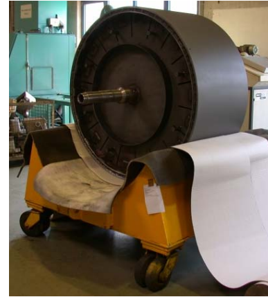
Bild 1-3: Antihafte Wirkung und Abrasionsschutz: Multifunktionale Beschichtungssysteme von Pallas tragen maßgeblich zur Produktions- und Anlagensicherheit von Walzen bei.
