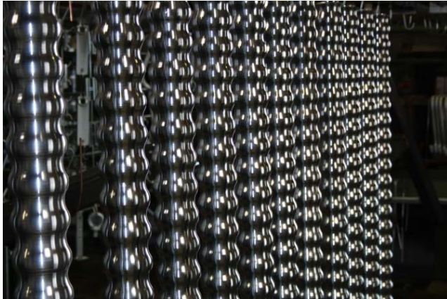
Bild 6-7: Auf der wellenförmigen Oberfläche von Transportrollen zeigt Chemisch Nickel seine Stärken in Konturtreue und Maßhaltigkeit.
