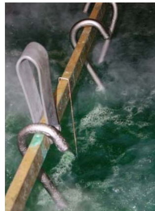
Bild 5: Die 800 Millimeter großen Hydraulikzylinder gehen zum Vernickeln auf Tauchstation in das mit Druckluft zum Sprudeln gebrachte Bad.
