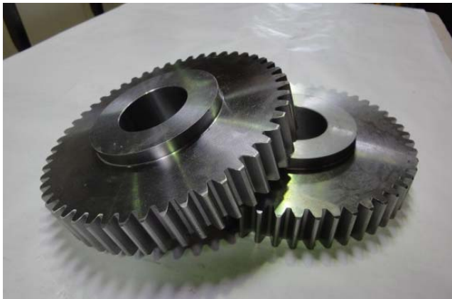
Bild 9: Insbesondere zur technischen Beschichtung von Bauteilen mit vielen Ecken und Kanten ist Chemisch Nickel unverzichtbar.
