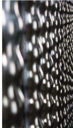
Bild 6-7: Auf der wellenförmigen Oberfläche von Transportrollen zeigt Chemisch Nickel seine Stärken in Konturtreue und Maßhaltigkeit.
