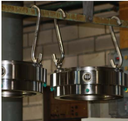
Bild 4: Als Gestellware bewegen sich die Hydraulikzylinder per Kran durch die Bäderstraße.
