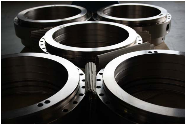
Bild 1-2: Bei Hydraulikzylindern mit bis zu 100 Millimeter tiefen Bohrlöchern und vielen Passungen ist Chemisch Nickel das Verfahren der Wahl.
