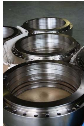
Bild 1-2: Bei Hydraulikzylindern mit bis zu 100 Millimeter tiefen Bohrlöchern und vielen Passungen ist Chemisch Nickel das Verfahren der Wahl.
