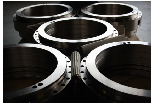
Bild 6: Bei Hydraulikzylinder mit einem Durchmesser von 800 Millimetern und 80 Kilogramm Stückgewicht ist Chemisch Nickel bei Pallas das Verfahren der Wahl.
