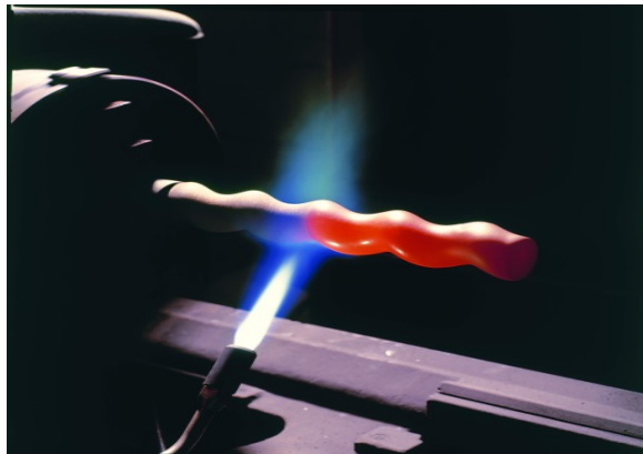
Bild 3: Reparaturbeschichtung: Pallas versieht Bauteile mit kostengünstigen und bis zu mehrere Millimeter dicken Schichten aus niedrigschmelzenden Metallen.
