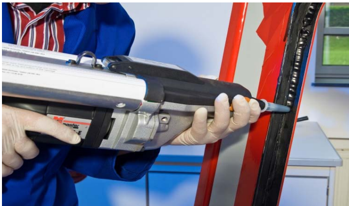
Bild 3: Kleben statt Schweißen: Hauptvorteile geklebter konstruktiver Verbindungen sind Kräfteinleitung über die Fläche anstelle von Punktbelastung.
