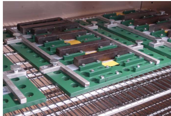
Bild 8: Durch die niedrige Oberflächen-Energie der PTFE-Beschichtung von Pallas fallen auch die bisher notwendigen Wartungsintervalle für die Prüfkörpervorrichtungen vollständig weg.
