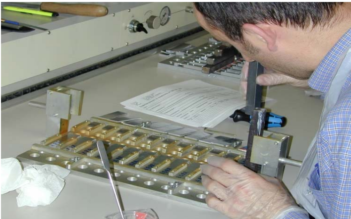
Bild 7: Enormer Kostenfaktor: Ohne PTFE-Beschichtung von Pallas musste die Prüfvorrichtung in ihre Einzelteile zerlegt werden, um Klebstoffreste zu entfernen.
