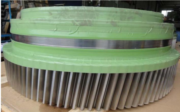
Bild 10: Antriebszahnräder für Großmaschinen: Die innen und außen nicht abgedeckten Stellen werden thermisch beschichtet, geschliffen und zur Auslieferung poliert.
