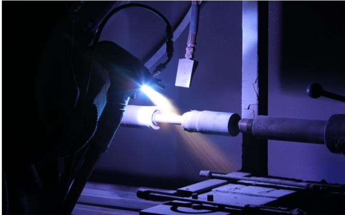
Bild 5: Verschleißfest: Atmosphärisches Plasmaspritzen verarbeitet in der bis zu 20.000 °C heißen Plasmaflamme sogar hochschmelzende Keramiken.
