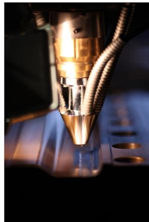
Bild 8-9: Laserverfahren verbessern Randschichteigenschaften von teuren, hochbeanspruchten Komponenten bei minimaler Belastung der Bauteile.
