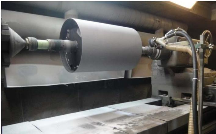
Bild 12: Die Laufrollen werden mit einem mobilen Sandstrahlgerät bearbeitet.
