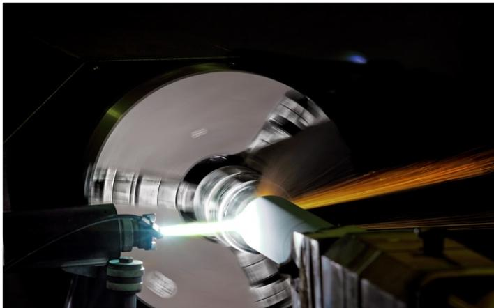
Bild 7: Die Verbindung hoher kinetischer Energie mit vergleichsweise niedriger thermischer Energie erzeugt beim HVOF sehr gut haftende, homogene und dichte Hartmetallschichten.
