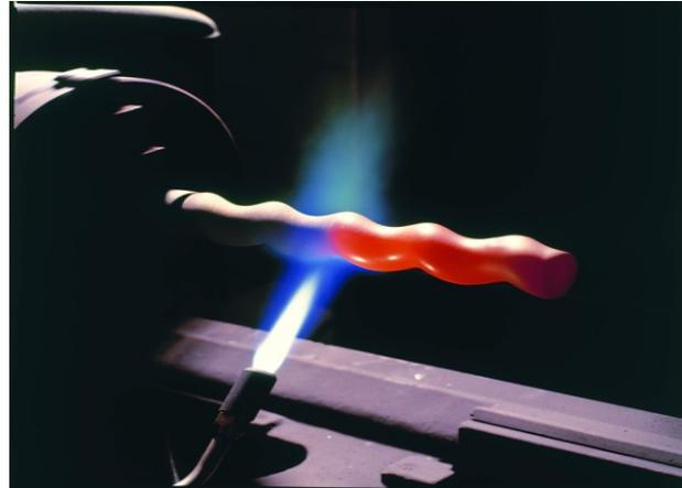
Bild 2: Reparaturbeschichtung: Pulverflammspritzen erzeugt bis zu mehrere Millimeter dicke Schichtstärken.
