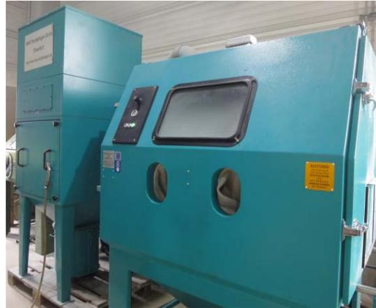
Bild 11: In der eigenen Strahlkabine bereitet Pallas Laufrollen für Bremsprüfstände für die Beschichtung vor.
