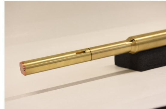
Bild 2: Die Verjüngung erlaubt durch einen um zwölf Millimeter geringeren Durchmesser als bei der Standard-iClad® eine Bearbeitungstiefe von 750 Millimetern.
