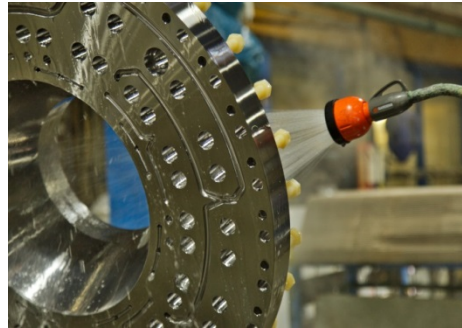
Bild 2: Mehrstufiger Reinigungsprozess nach sorgfältiger Abdeckung der Gewinde
