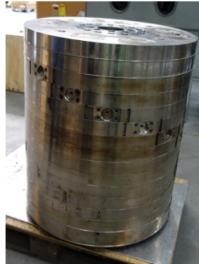
Bild 15: Modell eines Blaskopfes
