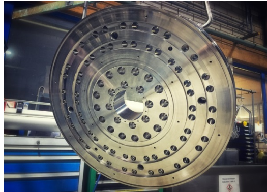
Bild 11: Wendel nach der chemischen Vernickelung
