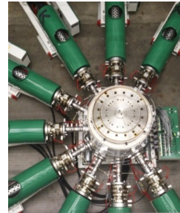
Bild 6: Smart Bubble® mit 9-Schicht-Extruder
