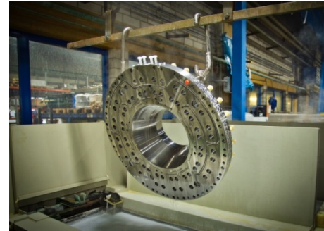
Bild 3: Beschichtungsdicke abhängig von Badaufenthaltsdauer des Wendel
