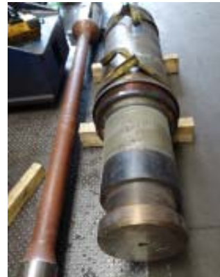
Bild 3: Die drei Tonnen schwere Richtachse nach dem Laserauftragschweißen
