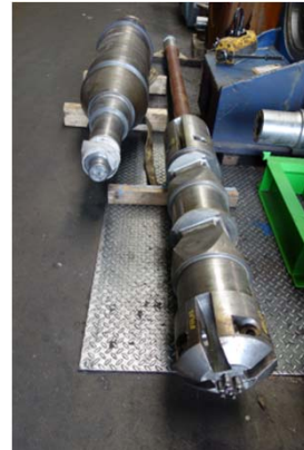
Bild 15: Spreizdorn nach Instandsetzung eines Lagers
