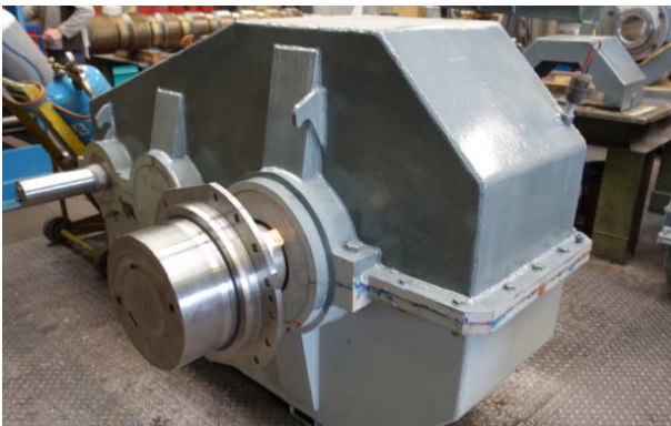
Bild 10: Komplett instandgesetztes Getriebe
