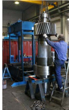
Bild 8: Montage der Richtachse
