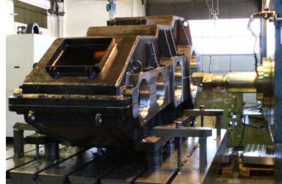
Bild 9: Bohrwerksbearbeitung eines Getriebegehäuses bei Schmidtke & Sohn
