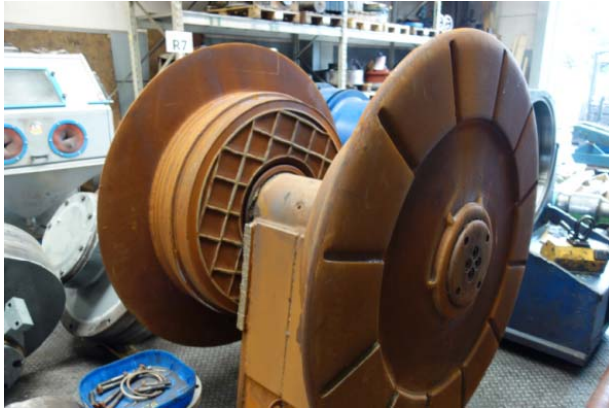
Bild 12: Unterturas für die Kies- und Sandindustrie vor Panzerauftragschweißen bei Schmidtke & Sohn
