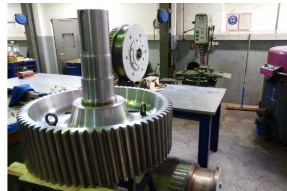
Bild 11: Montage einer Antriebswelle
