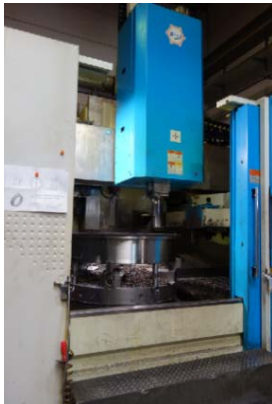
Bild 14: Auf der Karusseldrehmaschine von Schmidtke & Sohn können Impeller-Laufräder mit 1.200 Millimetern Durchmesser gedreht werden.
