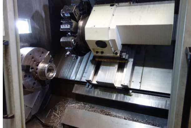
Bild 13: Fertigung von Drehteilen aus hochlegiertem Edelstahl
