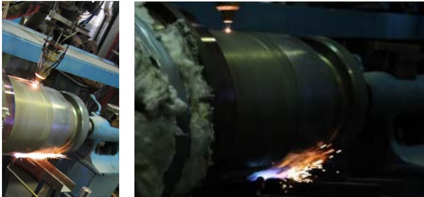
Bild 1-2: Hochpräzise erfolgt die Regenerierung der vorgewärmten Richtachse mit einem drei Millimeter großem Brennfleck per Laser.
