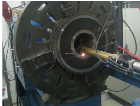
Bild 2: Schwer zugängliche Bohrungen von Getriebezahnrädern beschichtet Stork mit iClad.
