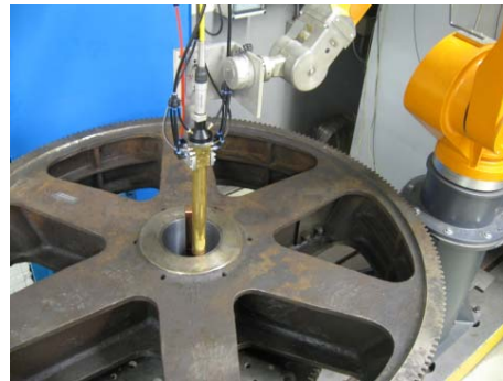
Bild 5: Auch in enger Umgebung (ab 50 mm Durchmesser) realisiert iClad hochwertige Beschichtungen bei Stork.
