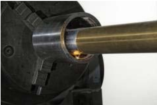
Bild 3: Auch in engster Umgebung (30 bis 50 mm) realisiert iClad® hochwertige Beschichtungen.
