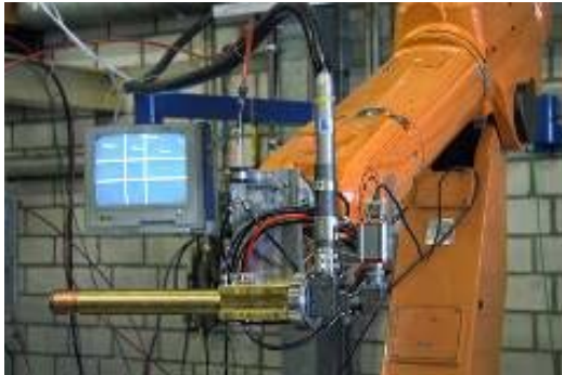
Bild 1: iClad® bietet die Möglichkeit, verschiedene Köpfe für unterschiedliche Beschichtungsaufgaben anzuschließen.
