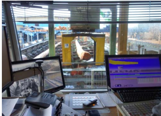
Bild 8: Die Messdaten des 3D-Lasers werden in der Kappstation computergestützt den Kundenaufträgen zugeordnet.
