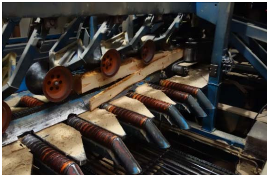
Bild 19: Der Spaner entfernt zwei gegenüberliegende Rundseiten des Stamms: Die dafür eingesetzten Schneidwerkzeuge sind in der Kreismesseraufnahme befestigt.
