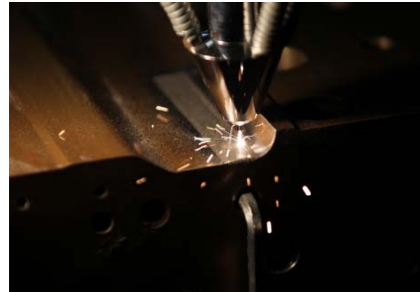
Bild 34: Beim Pulsen wird durch einen zeitlich eng begrenzten Impuls die Energie punktuell in das Material eingebracht, um so komplexe Geometrien zu reparieren.
