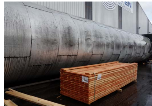
Bild 28: Im Vakuumtrockner wird Bauholz mit unterschiedlichen Dimensionen getrocknet.
