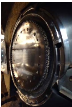
Bild 22-23: Die insgesamt vier Kreismesseraufnahmen sind extremen Bedingungen ausgesetzt: Hier werden Rindenreste und Unebenheiten entfernt und die Rundungen zu geraden Flächen geschnitten.
