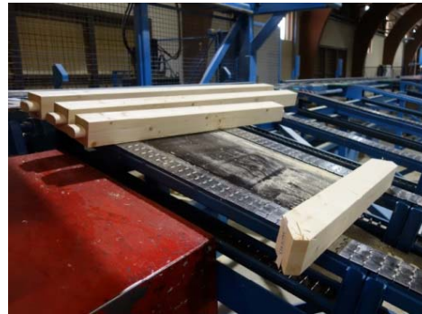
Bild 27: Die zugeschnittenen Bretter durchlaufen diverse Veredelungsstationen wie Hobel oder millimetergenaue Fixkappung.
