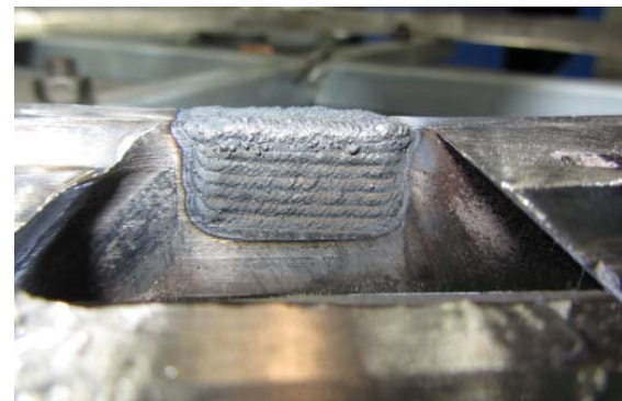
Bild 6: Pallas trug Schnellarbeitsstahl mit 63 HRC als Verschleißschutz auf die Kreismesseraufnahmen.
