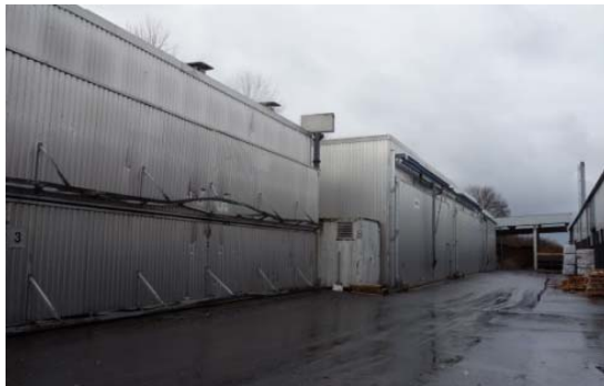
Bild 29: In den Trockenkammern wird das Holz getrocknet, um es für den Innenausbau nutzbar zu machen.
