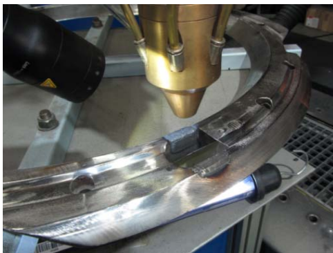
Bild 4-5: Der Beschichtungswerkstoff wird durch konzentrisch angeordnete Düsen gefördert und an der Beschichtungsfläche zusammen mit dem Grundwerkstoff an- beziehungsweise umgeschmolzen.
