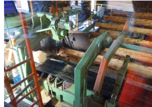
Bild 9: Per Laser werden die Stämme erstmals vermessen, um neben Länge und Durchmesser auch Besonderheiten wie Krümmung oder Ovalität zu erfassen.
