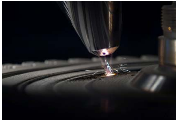
Bild 32-33: Für den 6 kW Diodenlaser entwickelte Pallas ein modulares Programm, das es dem Oberflächenspezialist erlaubte, an die Verschleißstruktur angepasst zu pulsen.
