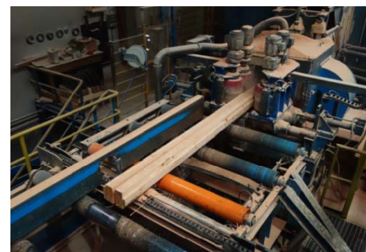
Bild 24: Ein zweiter Spaner trennt die verbliebenen Rundseiten ab, sodass ein rechteckiger Holzblock entsteht.
