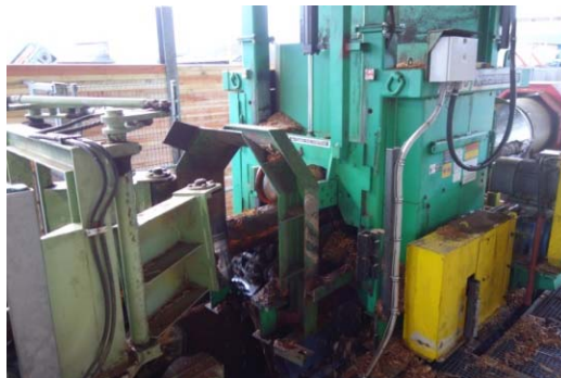
Bild 11: Ein erster Metalldetektor untersucht die Stämme auf Metallsplitter, Nägel und Munition.
