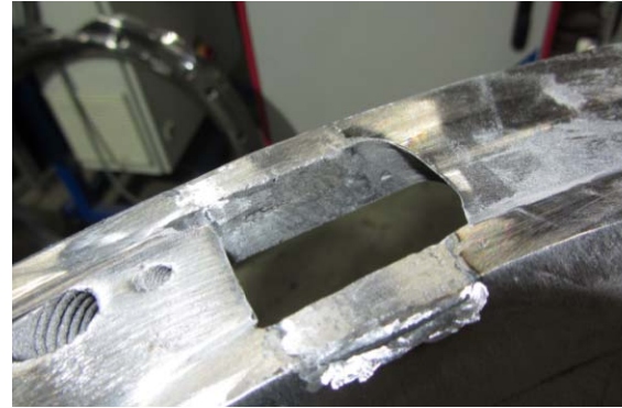
Bild 2-3: Durch eng begrenzten Wärmeeintrag ermöglicht Laserauftragschweißen eine hochpräzise Beschichtung und den Wiederaufbau von beschädigten Strukturen.
