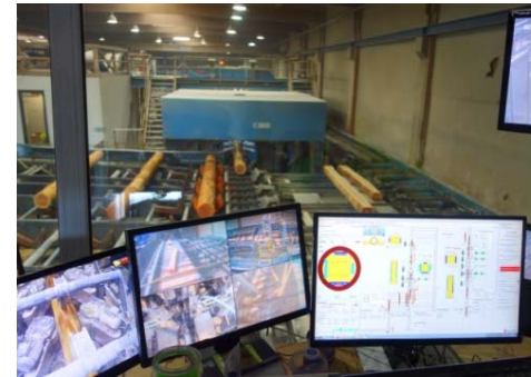
Bild 15: Im Sägewerk wird der Kundenauftrag komplett in die Quadroline-Anlage – vier Bandsägen mit Magnetführung – geladen.
