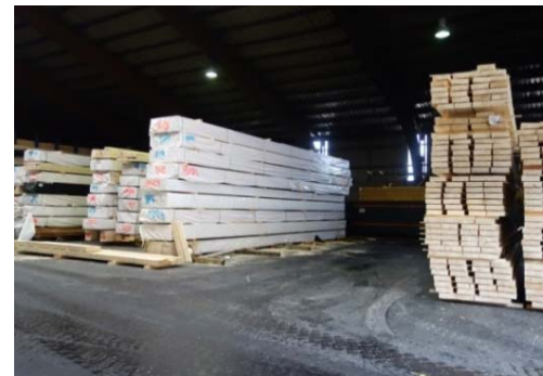
Bild 31: Zum Versand an den Kunden werden die Bretter gestapelt und umreift.
