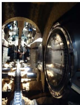
Bild 22-23: Die insgesamt vier Kreismesseraufnahmen sind extremen Bedingungen ausgesetzt: Hier werden Rindenreste und Unebenheiten entfernt und die Rundungen zu geraden Flächen geschnitten.
