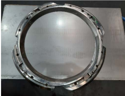
Bild 1: Pallas reparierte die Verschleißstellen an der 750 Millimeter großen, 300 Millimeter dicken Kreismesseraufnahme mit Laserauftragschweißen.
