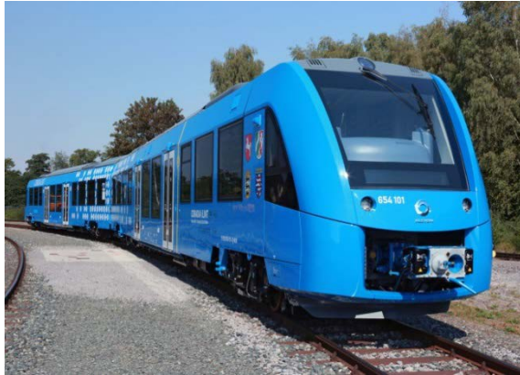
Bild 1-2: Beim „Coradia iLint“, dem weltweit ersten Niederfler-Personenzug, der mit einer Wasserstoff-Brennstoffzelle betrieben wird, sind Speicherbehälter, Leitungs- und Tanksysteme aus Edelstahl Rostfrei mit Qualitätssiegel.
