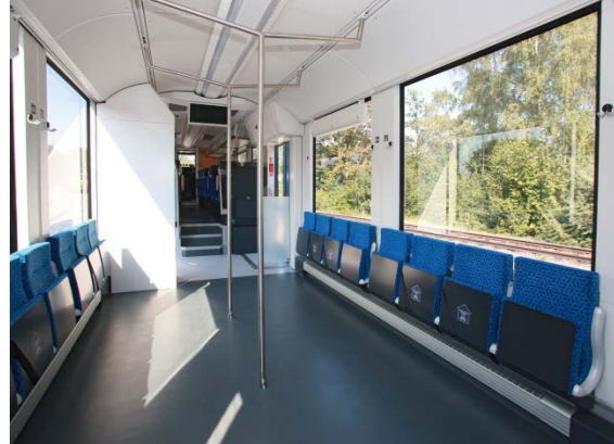
Bild 5-6: Auch bei der Innenausstattung setzen die Konstrukteure des „Coradia iLint“ auf vielseitigen Edelstahl Rostfrei mit Qualitätssiegel. So sorgen Handläufe, Griffe und horizontal unter der Decke verlaufende Stangen für allzeit sicheren Stand der Reisenden.
