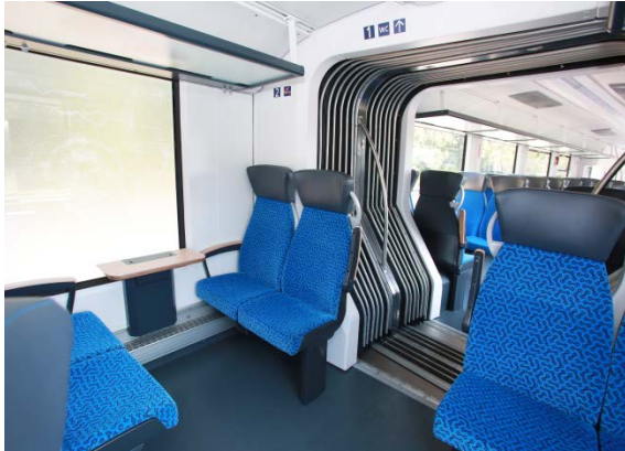
Bild 5-6: Auch bei der Innenausstattung setzen die Konstrukteure des „Coradia iLint“ auf vielseitigen Edelstahl Rostfrei mit Qualitätssiegel. So sorgen Handläufe, Griffe und horizontal unter der Decke verlaufende Stangen für allzeit sicheren Stand der Reisenden.
