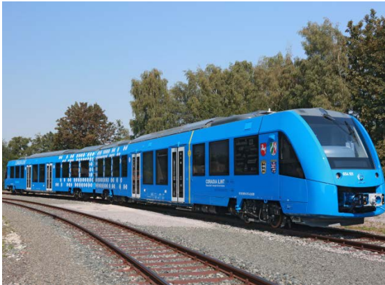
Bild 1-2: Beim „Coradia iLint“, dem weltweit ersten Niederfler-Personenzug, der mit einer Wasserstoff-Brennstoffzelle betrieben wird, sind Speicherbehälter, Leitungs- und Tanksysteme aus Edelstahl Rostfrei mit Qualitätssiegel.
