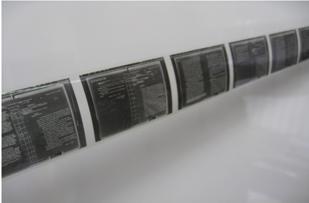
Bild 5: In Behältern aus nichtrostendem Stahl gelagert, sind Mikrofilme in puncto Haltbarkeit und zeitlich unbegrenzter Lesbarkeit jedem anderen Speichermedium überlegen.
