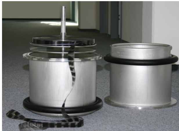
Bild 4: Immer 16 Großrollen werden übereinander in Behälter aus Edelstahl Rostfrei gepackt, bevor sie vier Wochen lang in einer Klimakammer lagern.
